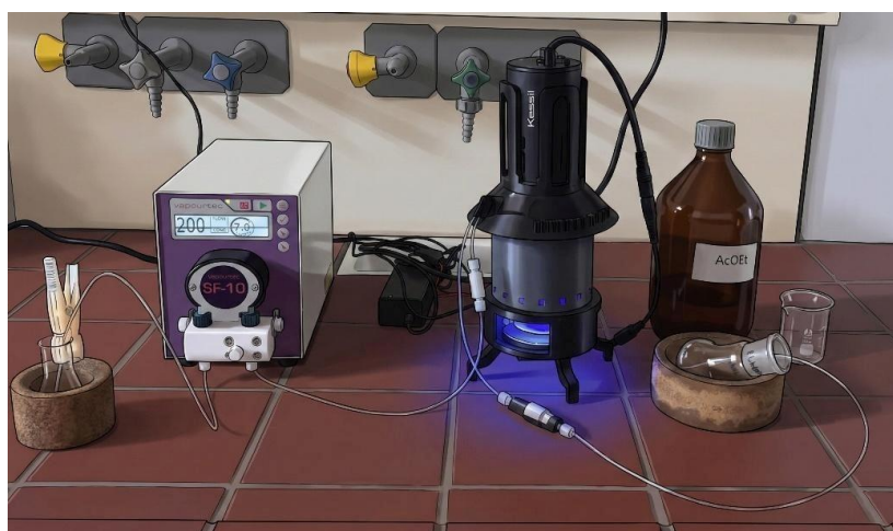
Εικόνα 10: Σύστημα συνεχούς ροής που χρησιμοποιήθηκε για τη διεκπεραίωση των αντιδράσεων, UFlow, συνολικού όγκου 8.15 mL, εσωτερικού όγκου 5.5 ml, συνδεδεμένο μέσω σωλήνωσης PTFE, εσωτερικής διαμέτρου 0.8 mm και εξωτερικής διαμέτρου 1.58 mm.
